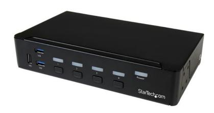
Mithilfe dieses 4-Port-USB 3.0-DisplayPort-KVM-Switches können Sie vier DisplayPort (DP)-Computer mit nur einem Monitor, einer Tastatur und einer Maus steuern. Der KVM ist auch mit 3,5-mm-Audio und einem integrierten 3-Port-USB 3.0-Hub ausgestattet.
