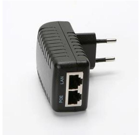
Mit dem Auerswald PoE Injector kann ein IEEE 802.3af kompatibles Netzwerkgerät, z. B. Wireless Access Point, IP-Telefon oder Netzwerkkamera, direkt über die Netzwerkleitung mit Strom versorgt werden. Damit ist der Anschluss dieser über die Netzwerkleitung versorgten Geräte auch an einen ungespeisten LAN Switchport möglich.
