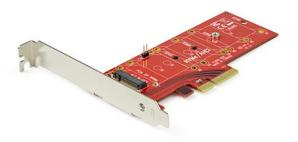
Erlangen Sie ultraschnellen Datenzugriff durch Hinzufügen eines PCIe M.2-SSDs zu Ihrem vorhandenen Computer. Mit diesem Adapter können Sie ein Hochgeschwindigkeits-4-Lane-M.2-SSD (PCIe-basiert), z. B. Samsung 950 Pro oder Samsung SM 951, zu einem PC mit einem freien x4-PCI Express-Erweiterungssteckplatz hinzufügen. Sie können das PCIe M.2 Laufwerk direkt am Adapter montieren, eine einfache und praktische Lösung zur Verbesserung der Systemleistung und Erweiterung des internen Speichers.
