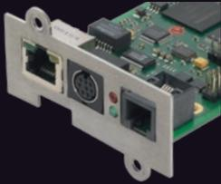
Der optionale **SNMP-Adapter** ist die professionelle Lösung zum Multiserver-Shutdown und zur Fernadministration der USV. Dank leistungsfähigem 32-Bit RISC-Prozessor unterstützt der SNMP-Adapter alle bekannten Funktionen
