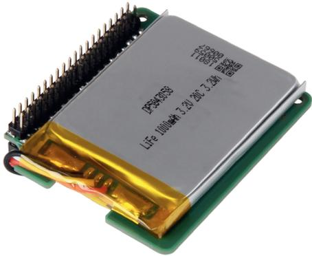
Dieses Battery Pack macht aus dem Strompi V3 eine vollwertige USV Lösung. Das Akkupack steht als dritte Stromquelle zur Verfügung, wird überwacht und automatisch nachgeladen.
